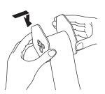
**6** Legen Sie die Aufwickelspule in die Aufnahme hinter dem Drucker über der Papierrolle.
