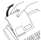
**2** Entfernen Sie den Batteriefachdeckel.
