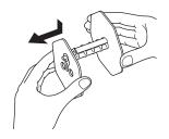
**4** Führen Sie das vordere Ende des Papierstreifens in die Nut im Kern der Aufwickelspule ein und wickeln Sie ihn um zwei oder drei Windungen auf den Kern.
