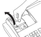
**3** Richten Sie die Papierrolle so aus, dass der Papierstreifen unter der Rolle herausgeführt wird, und legen Sie die Rolle in die Aufnahme hinter dem Drucker.
